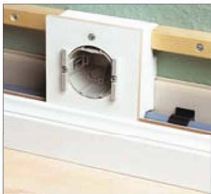
19. Stikkontaktmodulet placeres i bund-profilet. Frontpanelet skrues fast i væggen med den medleverede dybel 6x38 og skrue 4x70.
